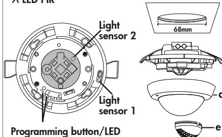
**! Beim Aufsetzen der Abdeckung (d) muss der Lichtsensor 1 frei bleiben.**
